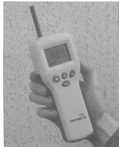
Le misure di umidità relativa (%rh) e di temperatura dell'aria (Tair) sono rilevati tramite il sensore della sonda **Hygrostick** collegata all'indicatore; lo strumento utilizza questi valori per calcolare il valore del punto di rugiada (Tdew)
