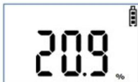
Lo strumento sarà in modalità "gas detection" con la schermata a display come mostrato nella figura qui a fianco, dopo la procedura di auto calibrazione precedentemente descritta.
